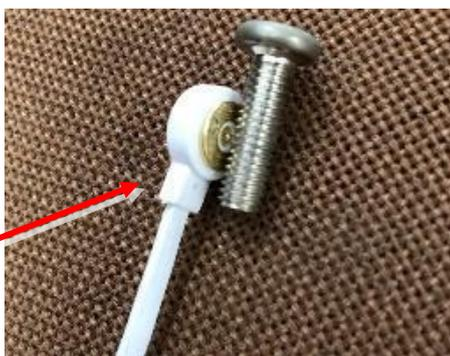
写真のように電源コードの磁石コネクター部に、製品本体以外の金属が付着した状態で電源ボタンが押された場合発熱により焼損、溶融、発煙に至る可能性があります。
